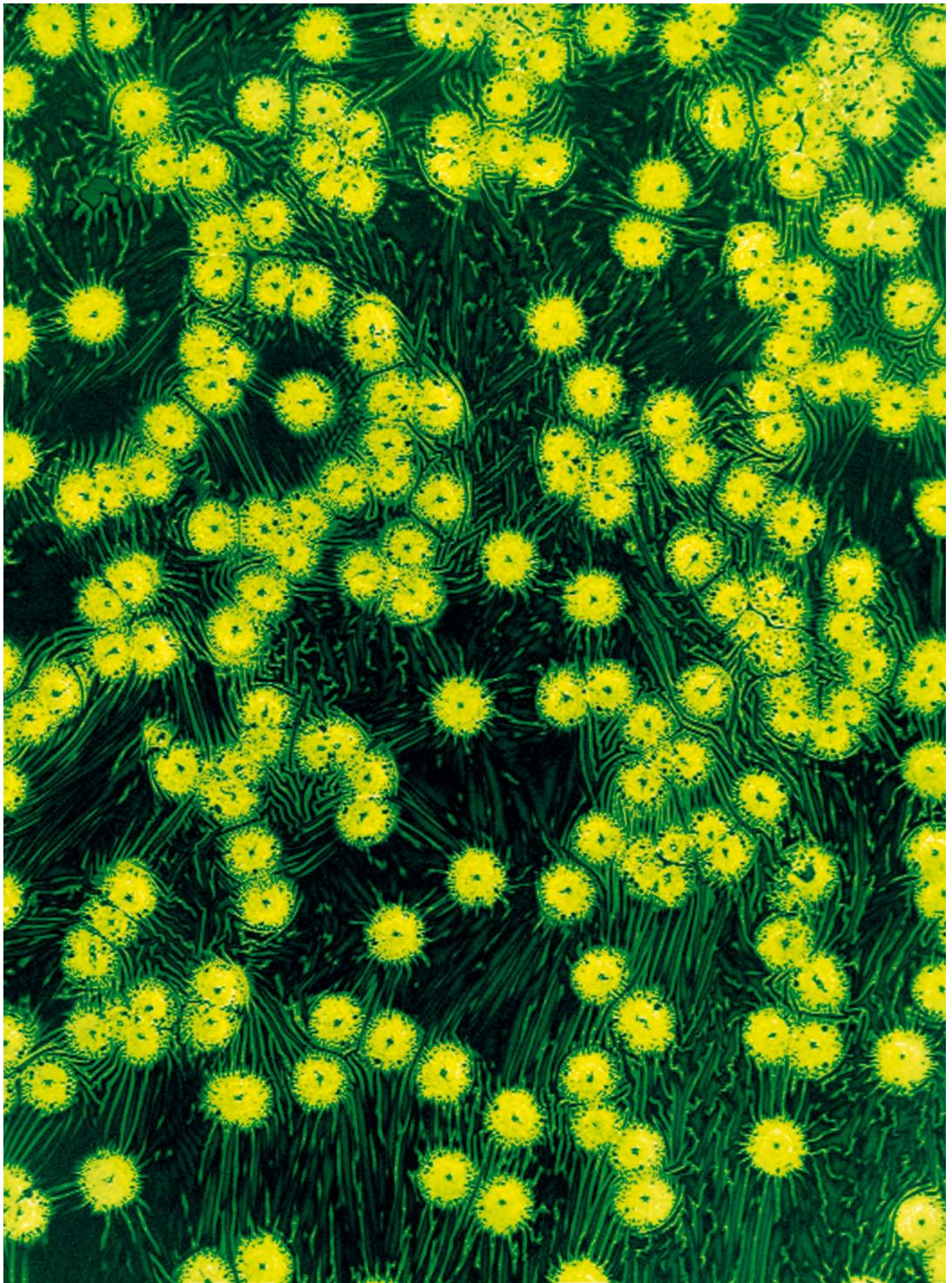
Elektronenmikroskopaufnahme von Salztröpfchen, die in gelartige Strukturen eingebettet sind. © Dr. Yuan Jiang, Prof. Dr. Helmut Cölfen, Prof. Dr. Markus Antonietti, Katja Schulze. Max-Planck-Institut für Kolloid- und Grenzflächenforschung.
